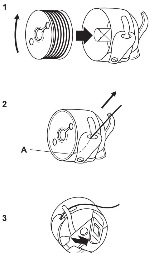
1. Возьмите шпульку в правую руку и вставьте ее в шпульный колпачок таким образом, чтобы при вытягивании нити шпулька вращалась по часовой стрелке (смотрите на рисунке).
