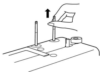
Катушечные стержни нужны для удержания катушек с нитками, чтобы нитка не затянулась в машину.
