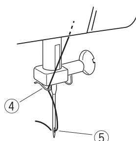
1. Пропустите нить через нитенаправитель на верхней крышке машины и проведите нить вниз вдоль правой прорези пластины нитепрятывателя.
